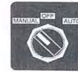
สวิทช์เลือกระบบการทำงาน MANUAL-OFF-AUTO
