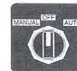
สวิทช์บิต MAN-OFF-AUTO เลือก OFF "หยุดการทำงาน"
